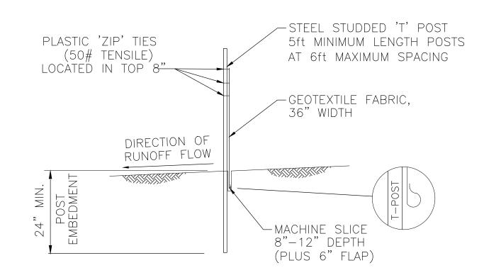
SILT FENCE - MACHINE SLICED
