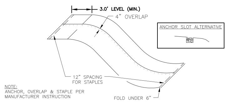
EROSION CONTROL BLANKET INSTALLATION
